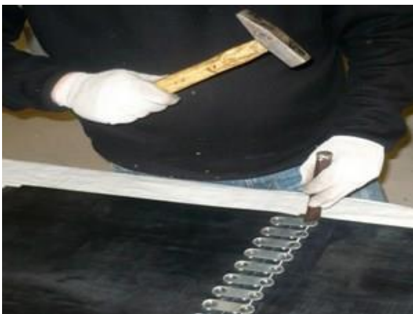
Чтобы гайки не откручивались в процессе эксплуатации конвейера, забиваем резьбу
