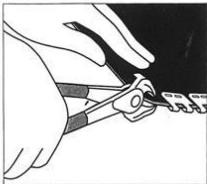
9. Край стыкуемой ленты (по направлению к движению) подрезать под небольшим углом, для предотвращения задевания ленты за ролик опоры. Аналогично монтируют полосу соединения на другом конце ленты.
